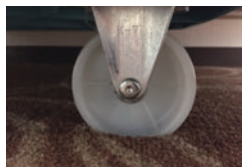
初期段階より凹みが発生します
