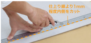
⑨裏面シートのカット 次に、裏面の生地を剥がすために、仕上がり線の部分を軽くカッターで切り込みます。 POINT: 巻込む生地の厚み1mm程度を考慮し、印の内側をカットする。
