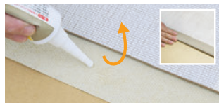
⑭巻込み部分の接着 表生地を裏面に接着剤等で貼り付けます。しわが入らないように引っ張りながら巻込みます。 ※接着剤等の選定・使用方法は、各取扱説明書を参考にしてください。
