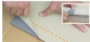
⑪表の巻込み生地を剥がす 表の生地を仕上がり線より少し大きめに剥がしてめくりまわす。 POINT: 生地に残ったポリエチレンシートは全て剥がしてください。
