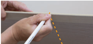
⑤裏面のカットラインを入れる 裏面への印を入れる。
